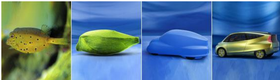
Obr. 12. Využití tvaru těla ryby při konstrukci nového vozu Mercedes-Benz Bionic Car [23].
