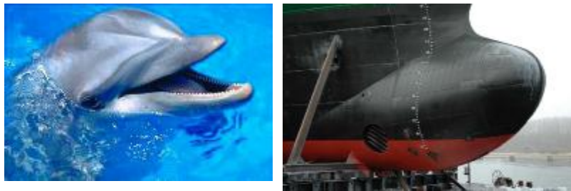
Obr. 3. Příklad aplikace tvaru trupu delfína při konstrukci lodí.
