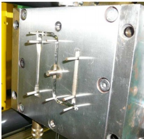
Obrázek 10 Forma pro vstřikování normalizovaných zkušebních těles [6]
