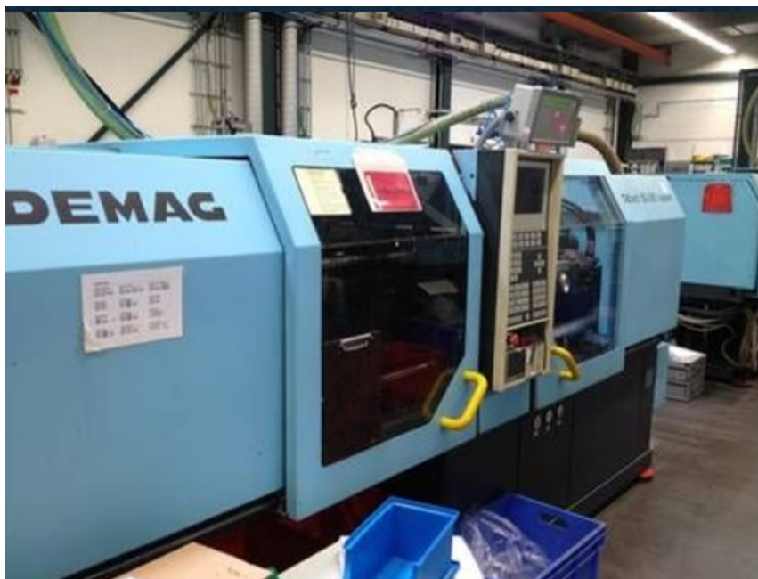
Obrázek 9 Vstřikovací stroj DEMAG ERGOtech 50-200 systém [24]
