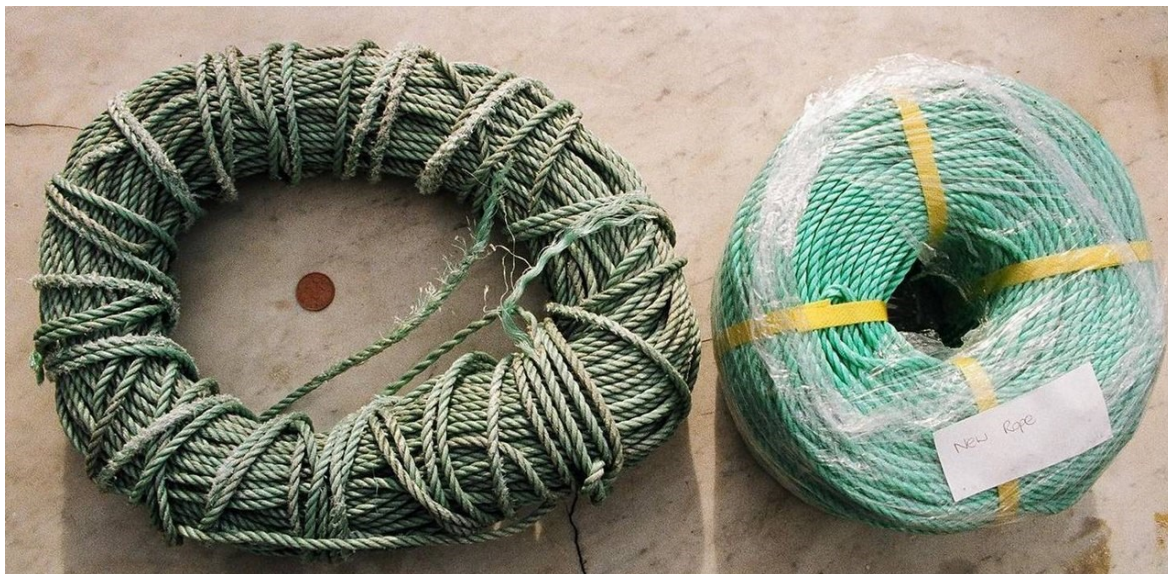
Obrázek 5 Porovnání degradovaného lana vlivem fotooxidace s novým lanem. [6]
