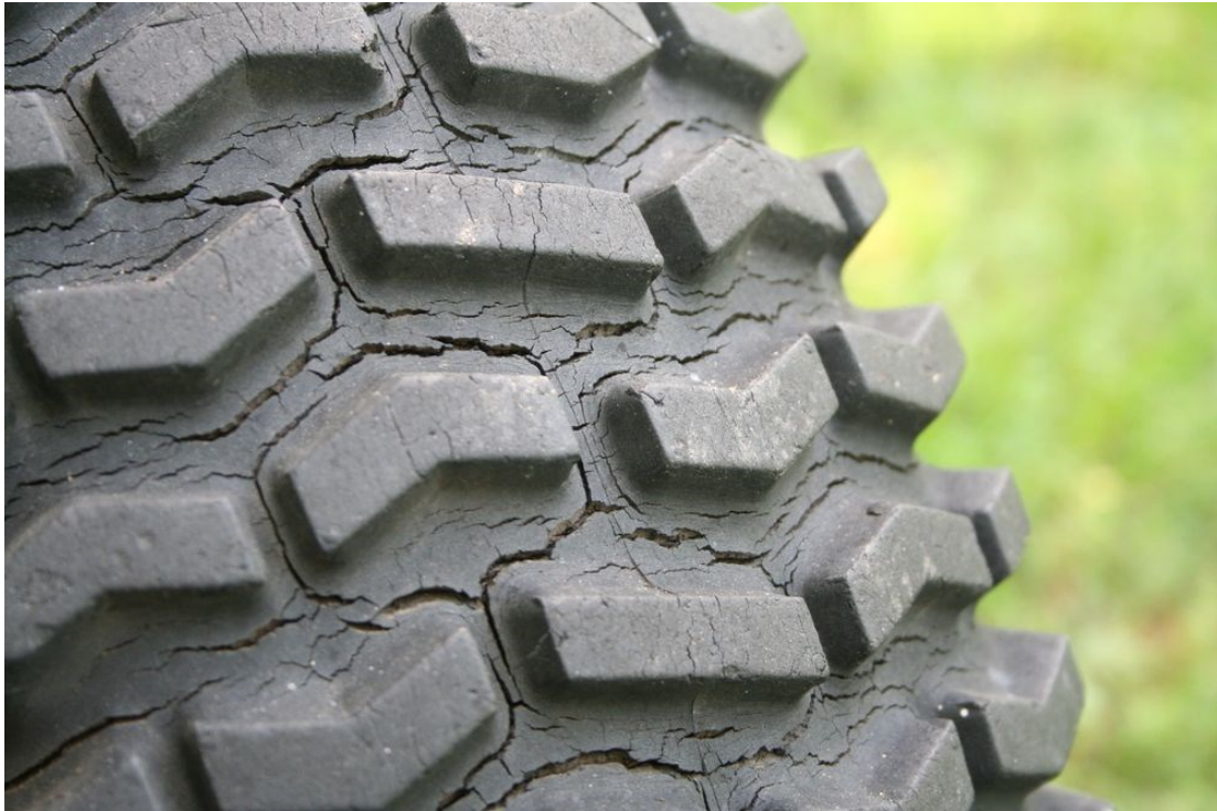
Obrázek 7 Tvorba trhlinek na pneumatice vlivem ozonu. [15]
