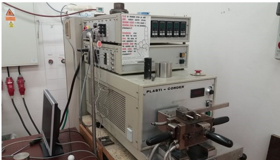
Obr. 18 Laboratorní hnětič Brabender [33]
