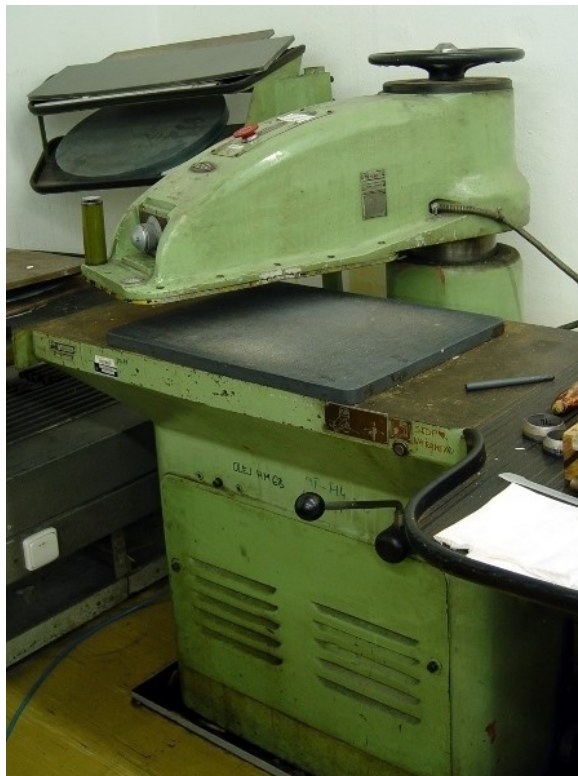
Obr. 21 Vysekávací stroj ZPS 06102 P1 [33]
