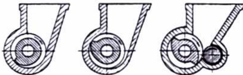
Obr. 5. Provedení plnicího otvoru
