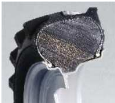
Obr. 12. Naplněný plášť PUR pěnou
