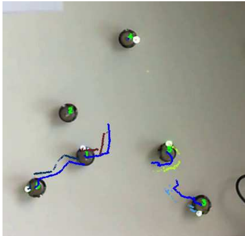
Obrázek 29. Porovnání detekovaných trajektorií a LED diod
