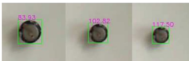
Obrázek 25. Programově změřené vzdálenosti před korekcí
