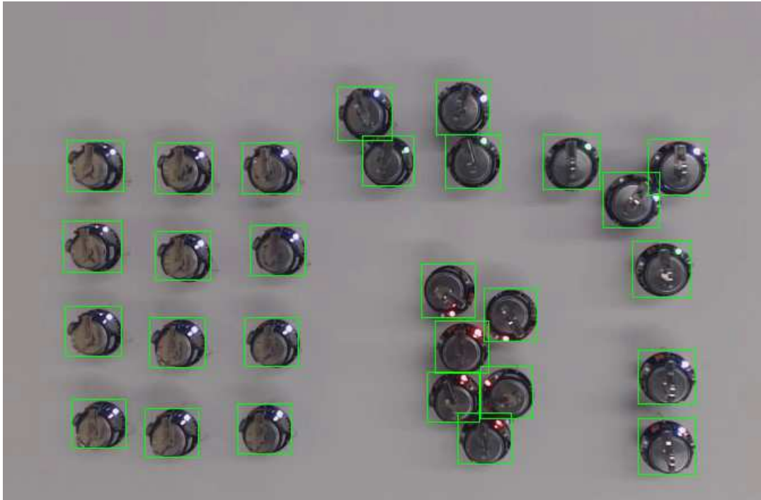
Obrázek 20. Detekování Kilobotů po aplikaci funkce NMSBoxes
