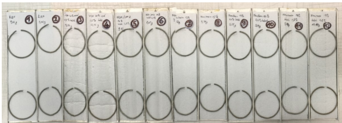
Obrázek 21 Vzorky pěn před umístěním do QUV testeru
