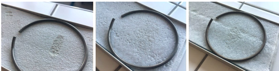
Obrázek 23 Změna struktury pěn po dvou týdnech v QUV testeru, označení vzorků zleva: 1, 10 a 12
