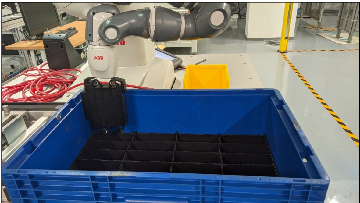
Obrázek 54: Ukázka zakládání kusu do KLT boxu na robotu IRB 14000 YuMi
