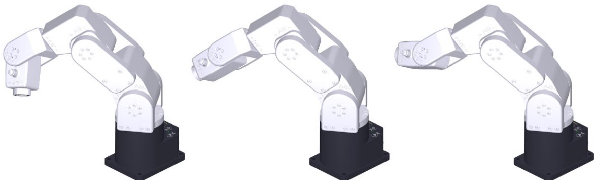
Obrázek 31: Poloha pod singularitou (vlevo) singularita zápěstí (střed), a poloha nad singularitou (vpravo) [26]
