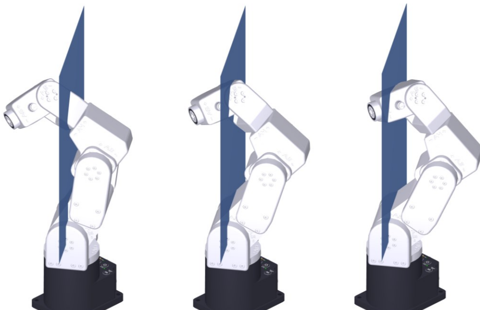
Obrázek 33: Poloha před singularitou (vlevo) singularita ramene (střed), a poloha za singularitou (vpravo) [26]
