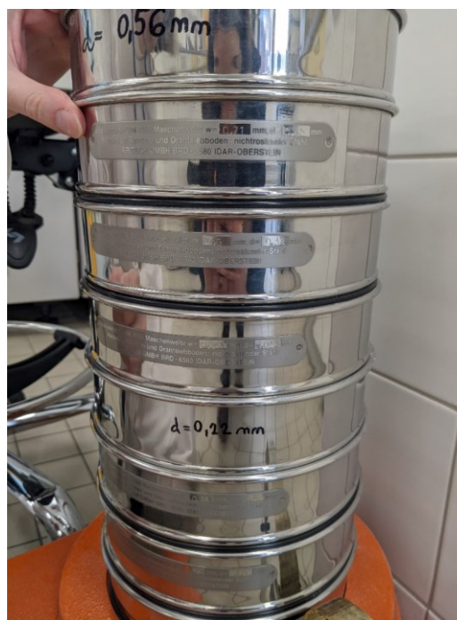
Obrázek č. 16 a č. 17 Síťová třepačka Fritsch Vibratory sieve shaker Analysette 3
