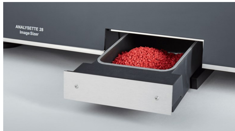
Obrázek č. 20 Sběrná nádoba třídiče částic [48]
