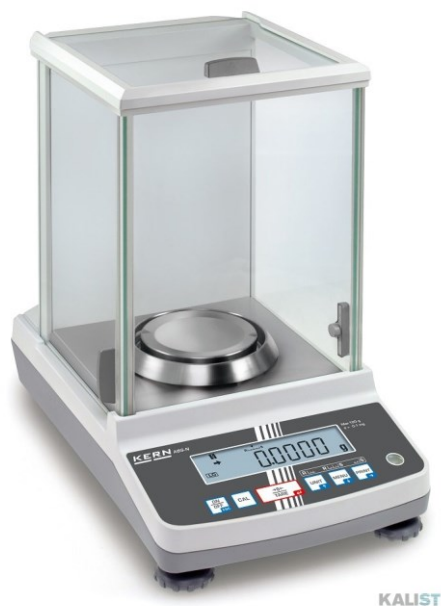
Obrázek č. 18 Analytické váhy KERN ABS [46]
