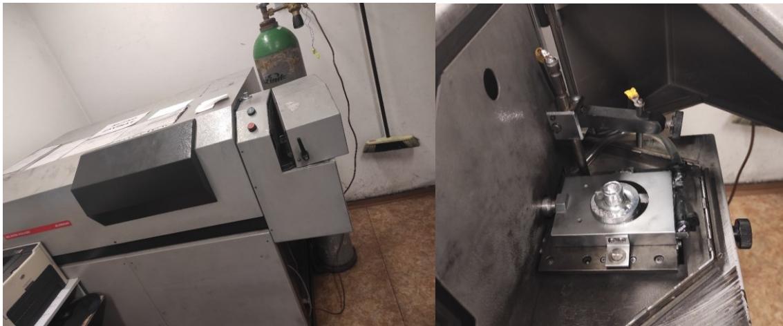
Obrázek 28: Analyzátor kovů ARL 3460 vícekanálový optický emisní spektrometr
