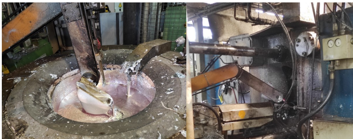
Obrázek 35: Dávkování taveniny keramickou naběračkou z udržovací pece
