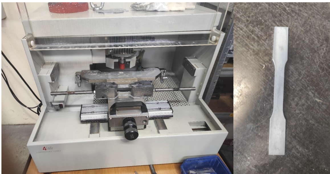
Obrázek 55: Laboratorní broušící zařízení pro výrobu zkušebních tyčinek
