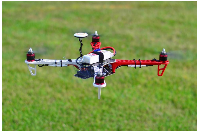
Obrázek 16 Dron s rákem z polyamidu 12 [30]
