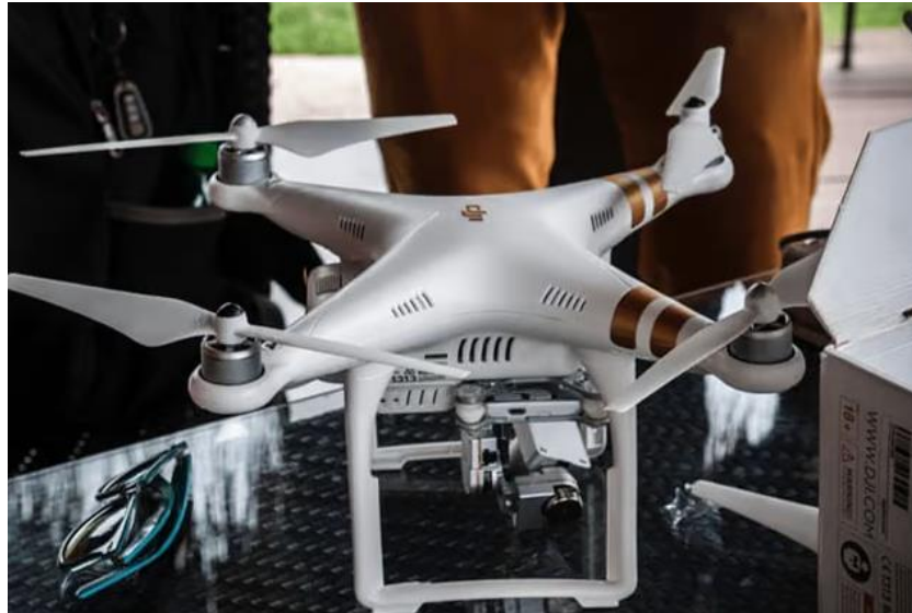
Obrázek 17 Dron s rámem ze slitiny hořčíku [28]
