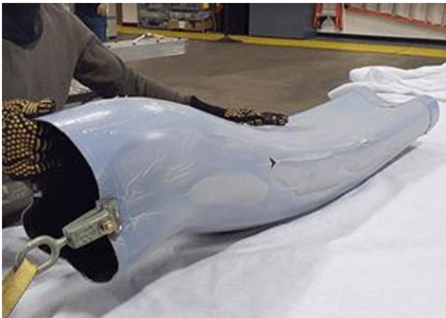
Obrázek 13 Trn s vytvrzeným laminátem před vložením do pece na dotvrzení. [20]
