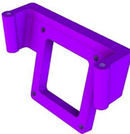
Obrázek 24 Upevnění FPV kamery
