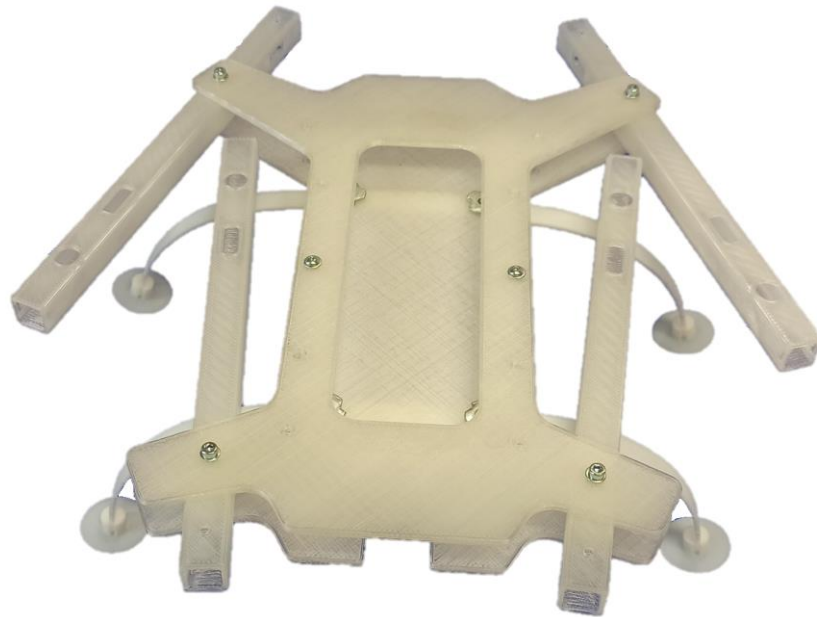
Obrázek 35 Prototyp kostry dronu vytisknutý 3D tiskárnou
