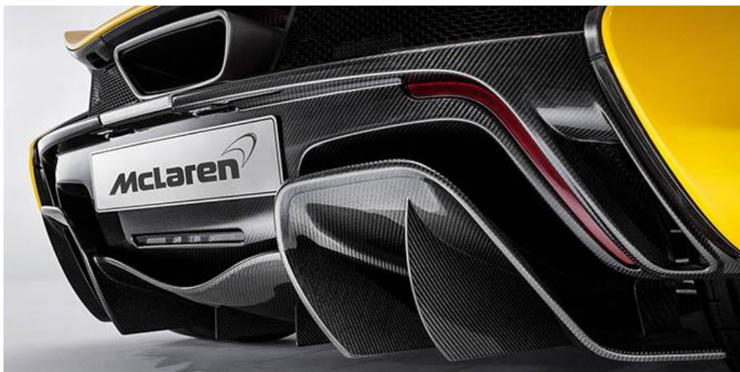
Obrázek 1 Příklad využití kompozitu v automotive – Nárazník McLaren P1 [3]
