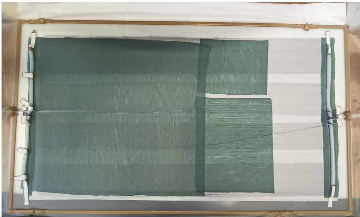
Obrázek 38 Vakuová infuze – systém připravený k prosycování výztuže
