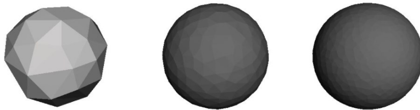
Obrázek 21. Rozlišení výsledného objektu v závislosti na počtu trojúhelníků [16]
