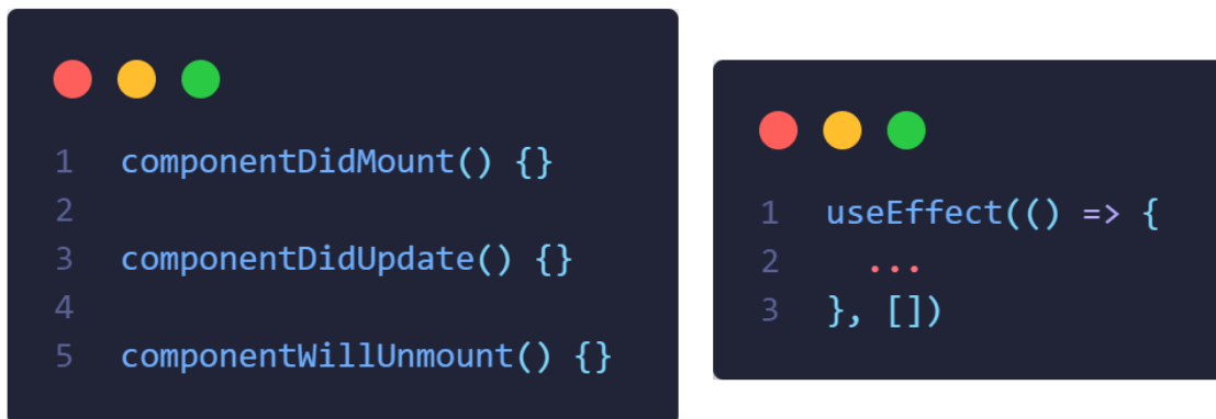
Obrázek 4.9 Rozdíl mezi životním cyklem třídy (vlevo) a React Hooks (vpravo)
