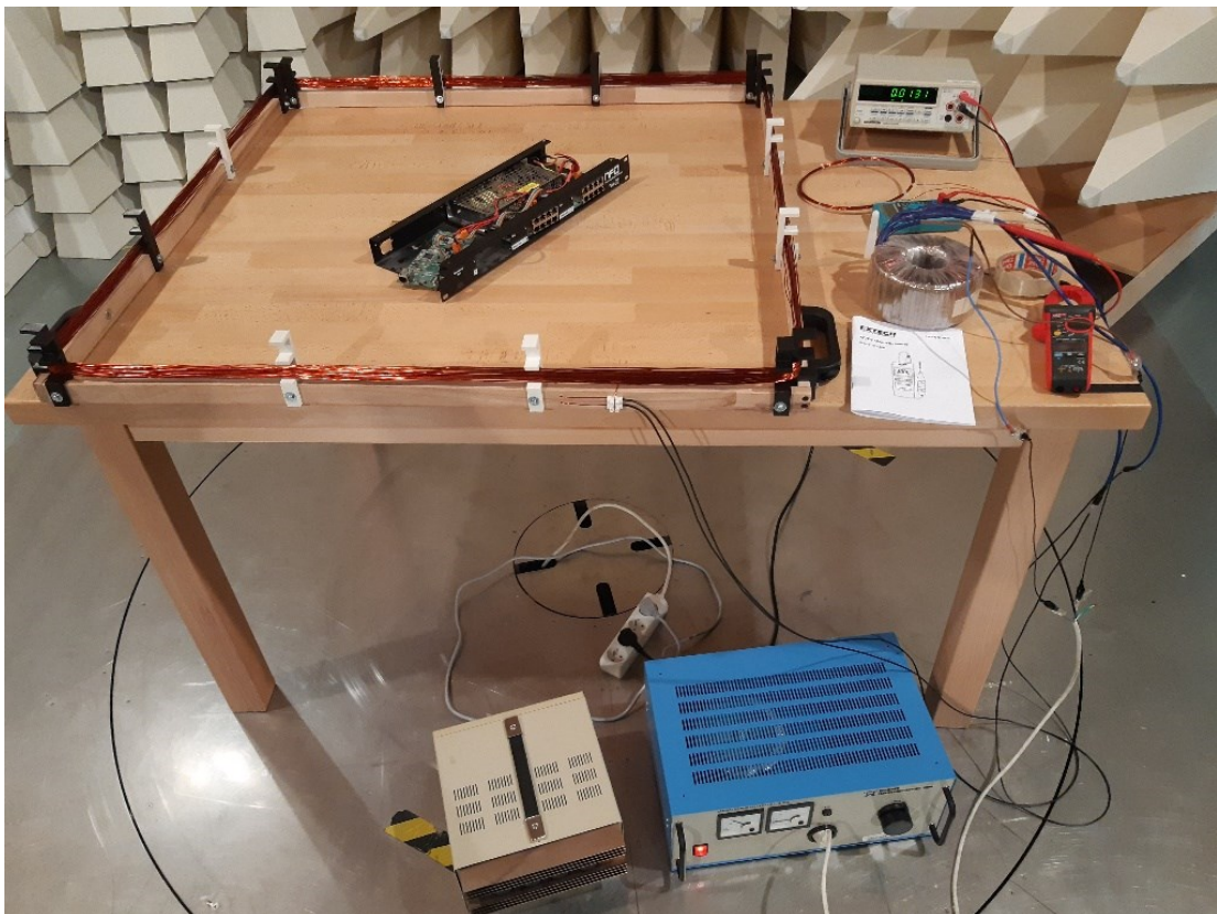
Obrázek 11. Měření zkušební cívky v laboratoři EMC
