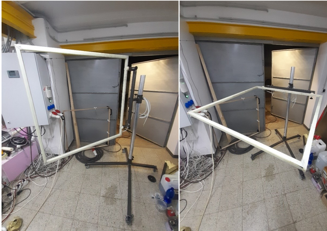
Obrázek 37. Zkouška stability nosné konstrukce s cívkou
