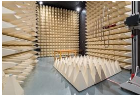
Obrázek 3. Příklad bezodrazové komory
