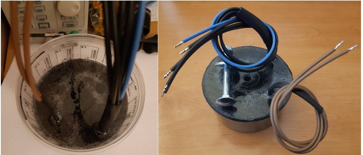
Obrázek 24. Zalití transformátoru do epoxidu a následné dokončení
