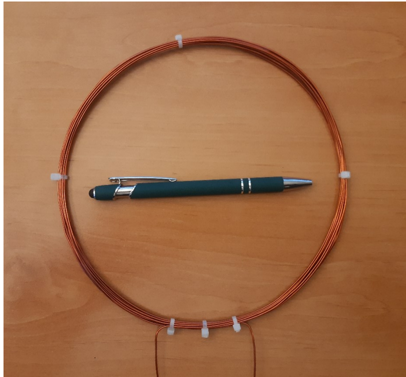
Obrázek 12. Zkušební cívka pro určení intenzity magnetického pole
