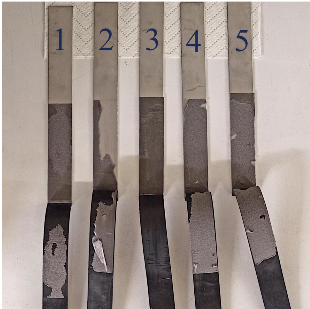
Obrázek 42: Vzorky po odlupování – PX5008 – s primerem
