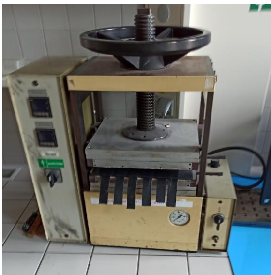
Obrázek 46: Vyroběné vzorky stlačené v ručním lisu (při pokojové teplotě)
