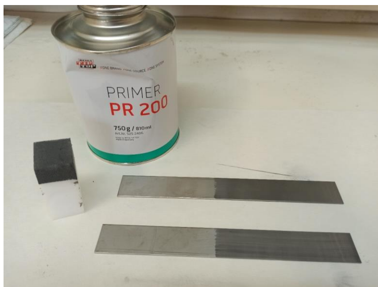
Obrázek 45: Primer PR 200 nanesený na povrch kovu melaminovou houbičkou
