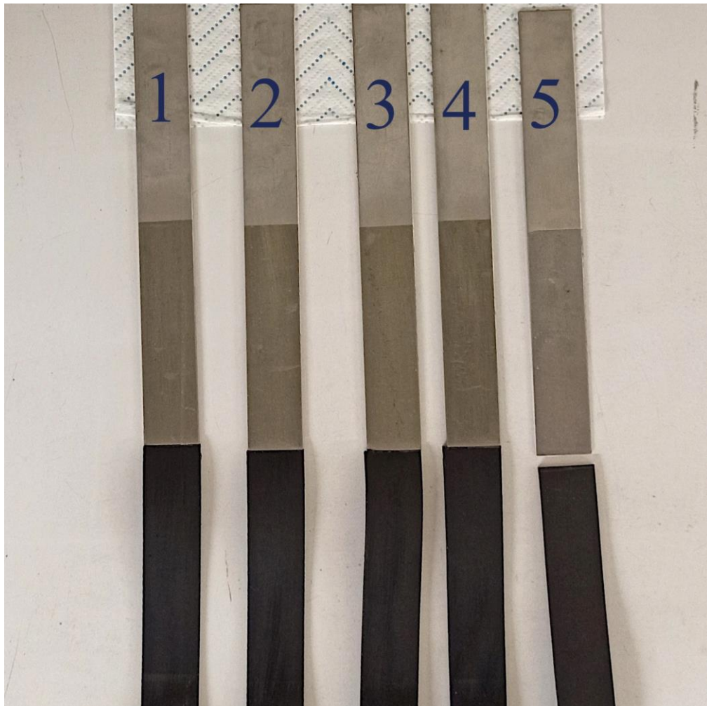
Obrázek 30: Vzorky po odlupování – 468MP– bez primeru
