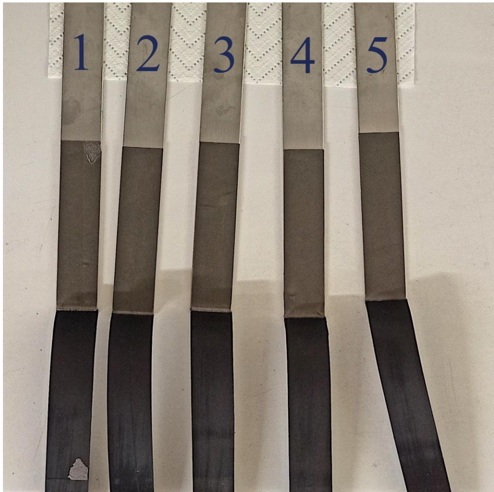
Obrázek 40: Vzorky po odlupování – PX5008 – bez primeru
