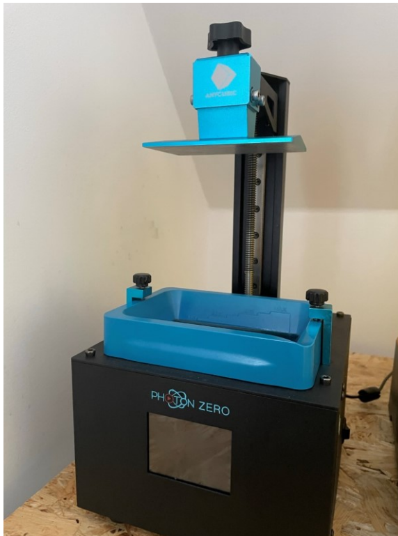
Obrázek 38 Použitá DLP tiskárna Anycubic Photon Zero
