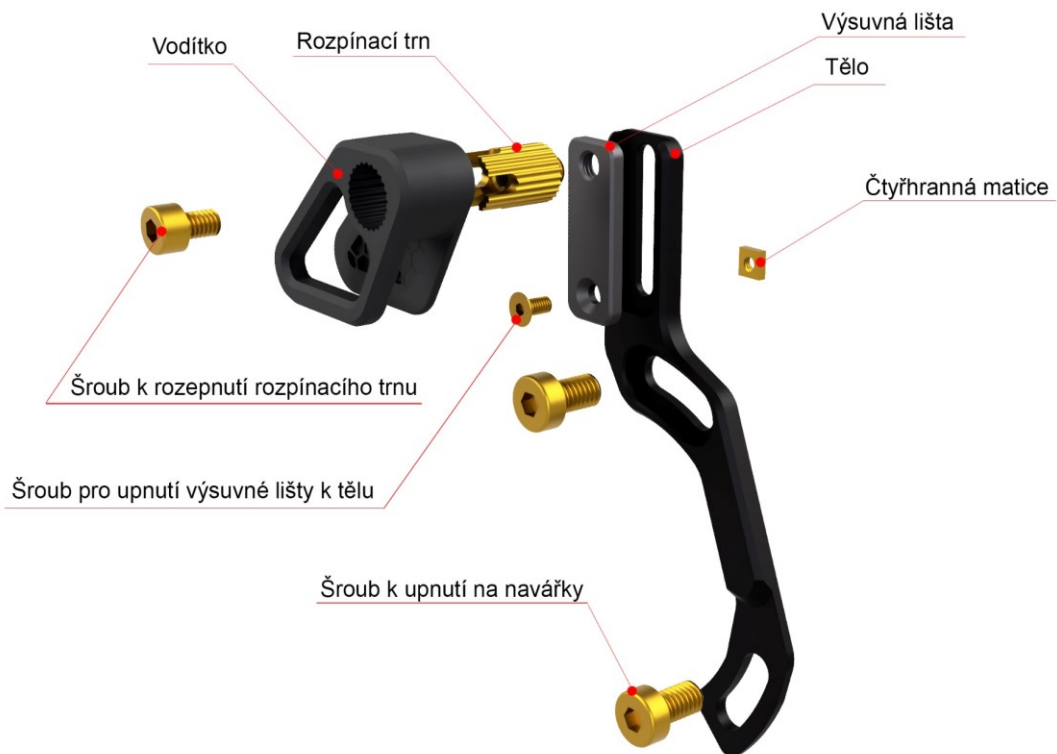
Obrázek 45 Pojmenování jednotlivých dílů sestavy druhé varianty
