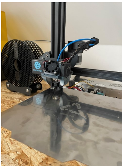
Obrázek 37 Použitá FDM tiskárna Kingroon KP3
