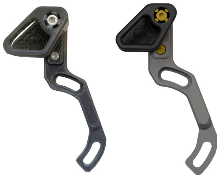
Obrázek 54 Přední pohled první varianty, vlevo vyrobená sestava, vpravo 3D model
