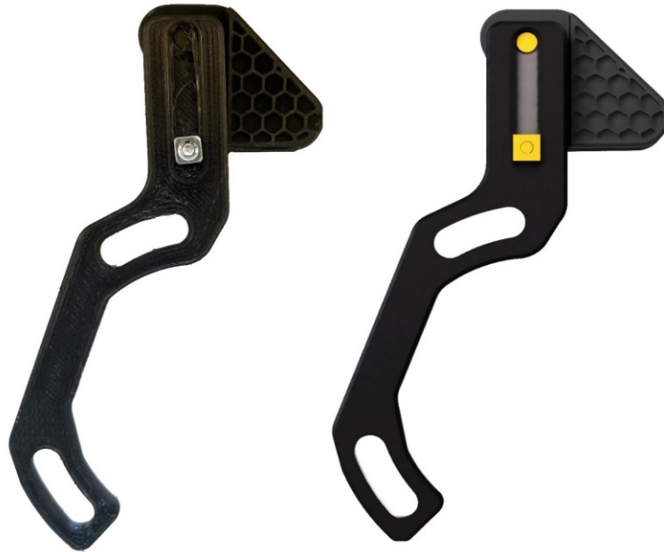
Obrázek 58 Zadní pohled druhé varianty, vlevo vyrobená sestava, vpravo 3D model
