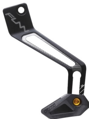
Obrázek 13 D-typ uchycení vodítka řetězu [39]
