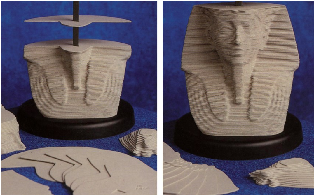
Obrázok 1 Princíp technológie vrstiev na ukážke sochárskych puzzlí [2]
