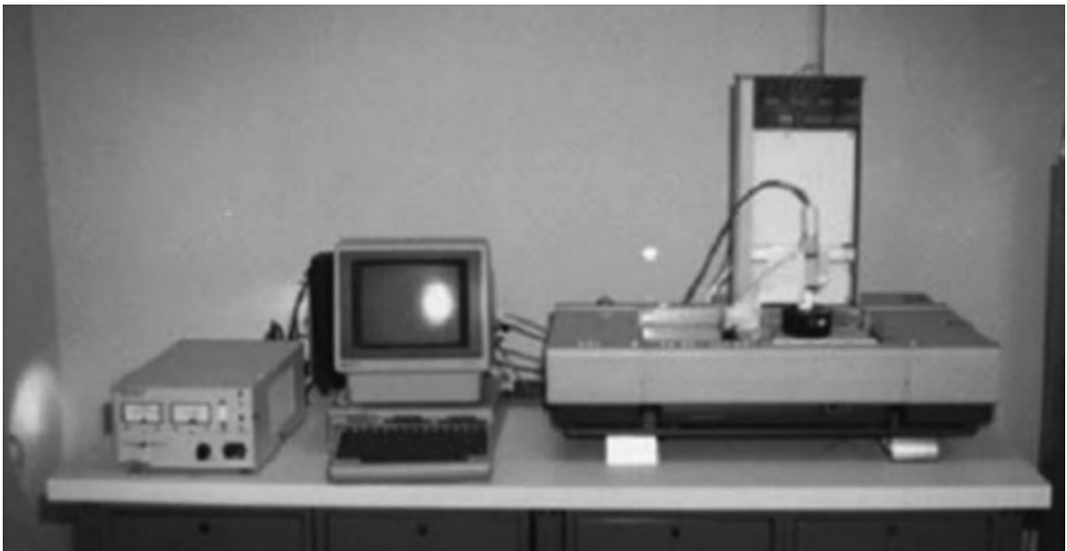
Obrázok 2 Prvá technológia aditívnej výroby Charlesa W. Hulla, ktorý vynášiel 3D systémy [3]
