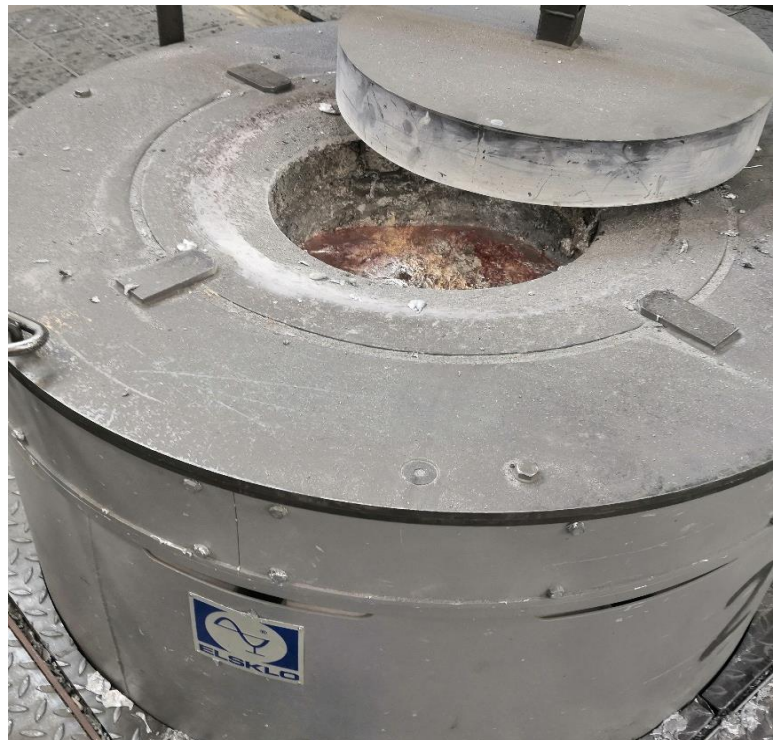
Obrázek 8 Pohled na tavicí pec s taveninou (zdroj vlastní)
