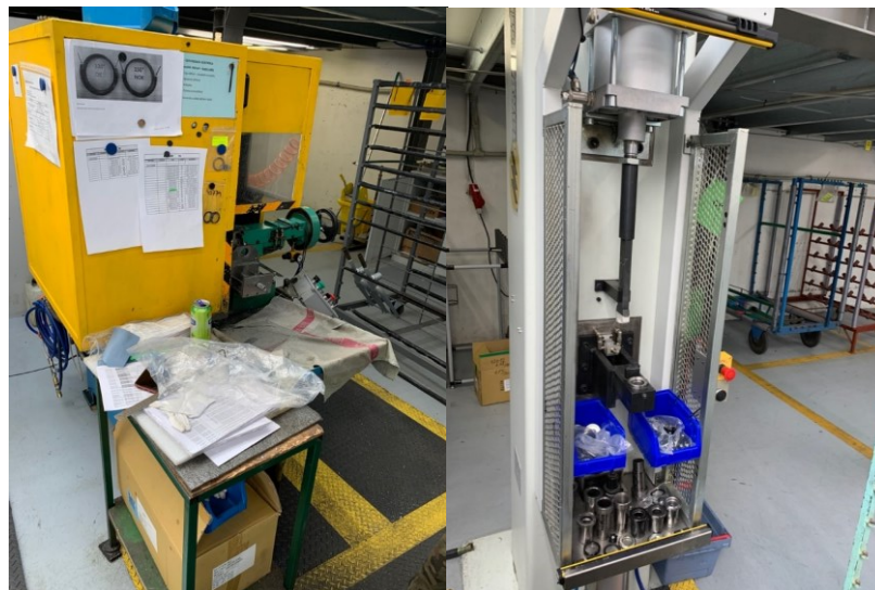
Obrázek 19 Pila na zkracování vidlic (obrázek vlevo) a lis na lisování závitů (obrázek vpravo) – (vlastní zpracování)
