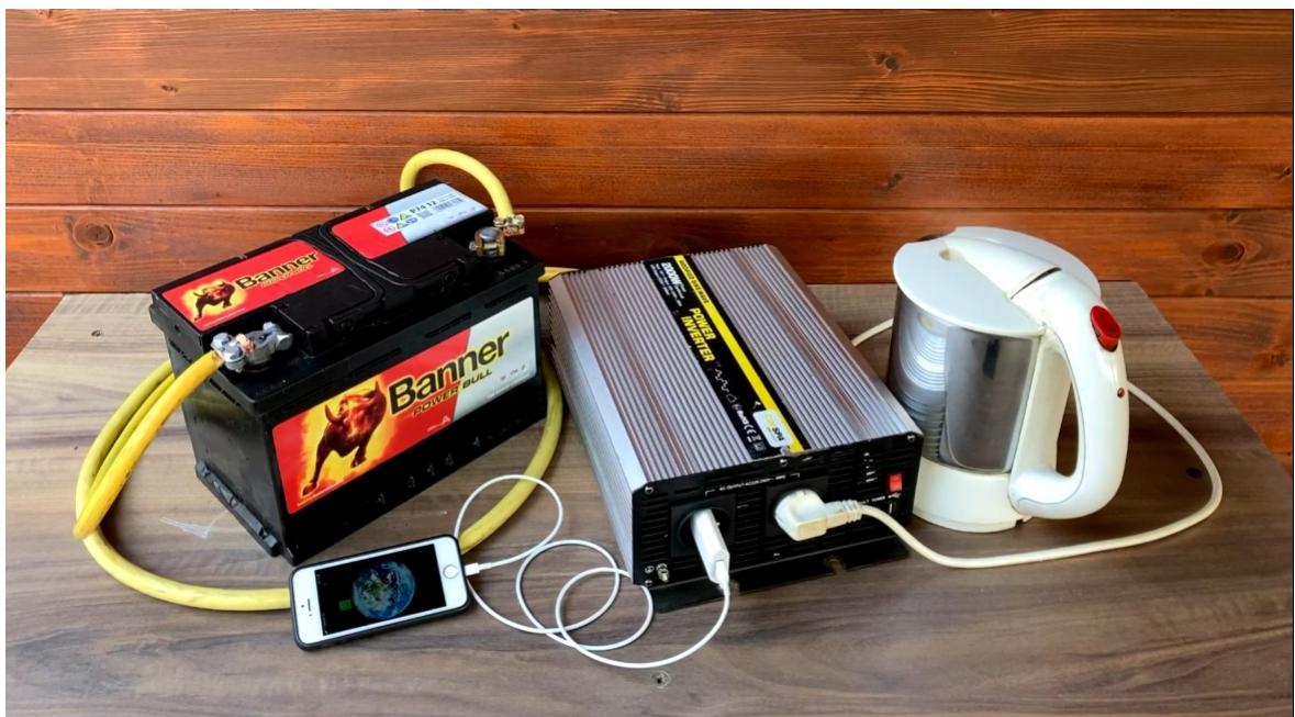
Obrázek 9: Ohřev vody a dobíjení mobilního telefonu přes měnič napětí pomocí 12 V akumulátoru. Zdroj: vlastní.
