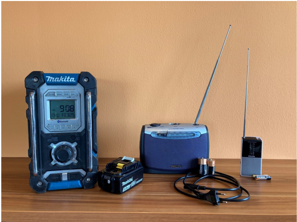
Obrázek 11: Rozhlasové přijímače. Zleva: stavební akumulátorové rádio; analogové rádio s možností napájení ze sítě nebo bateriemi; kapesní analogové rádio. Zdroj: vlastní.
