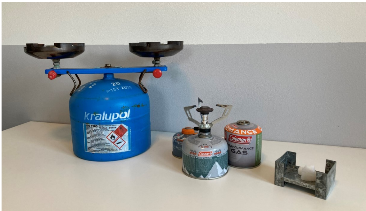
Obrázek 4: Přenosné vařiče. Zleva: Kempingový vařič s 2 kg PB lahví; turistický plynový vařič s náhradními kartušemi; vařič na tuhý líh. Zdroj: vlastní.
