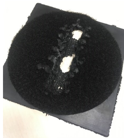
Obr. č. 8 – Poškozený vzorek kvůli špatným podmínkám ultrazvukového svařování
