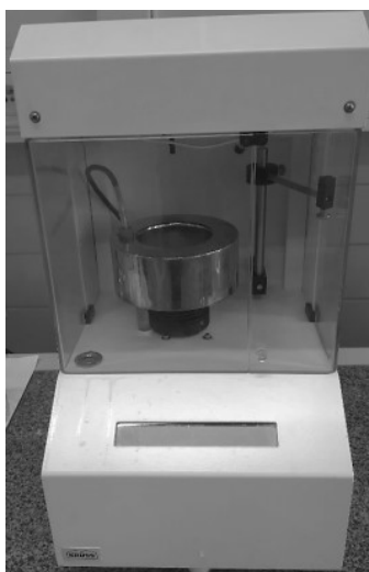
Obr. 31. Tensiometr Krüss K100MK3
