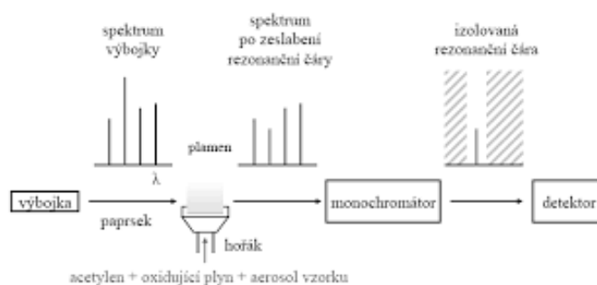
Obrázek č. 5: Zjednodušené schéma měření v AAS [86].
