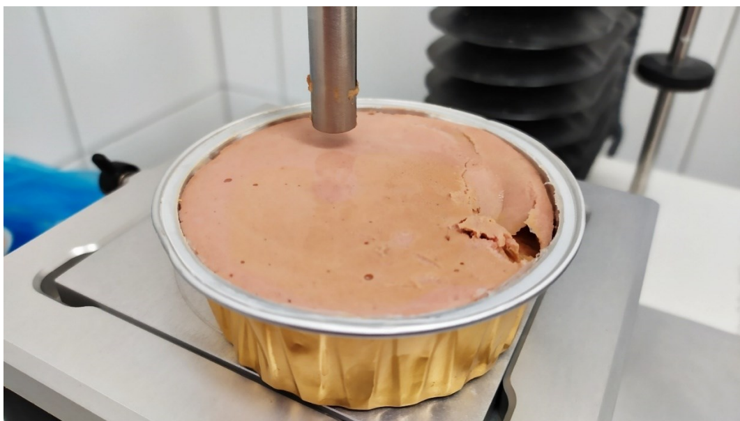
Obr. 4. Měření textury experimentálních vzorků kuřecí játrovky na přístroji TA-XT plus [Foto autorka]
