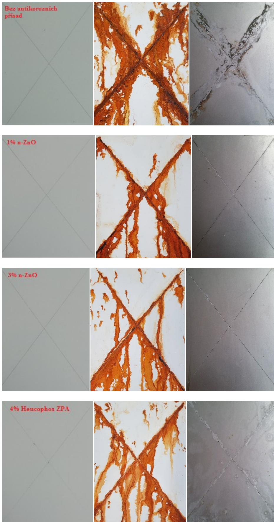
Obrázek 35. Výsledky vzorků akrylového pojiva po provedení testu solnou mlhou.
