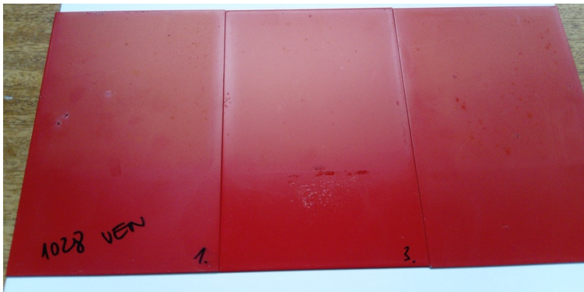
Obrázek 38. Vzorky po ukončení urychleného stárnutí dle ČSN EN ISO 11997-2, 1) Vzorek bez aditiv, 3) Vzorek s komerčním stabilizátorem 5) Vzorek s n-ZnO.
