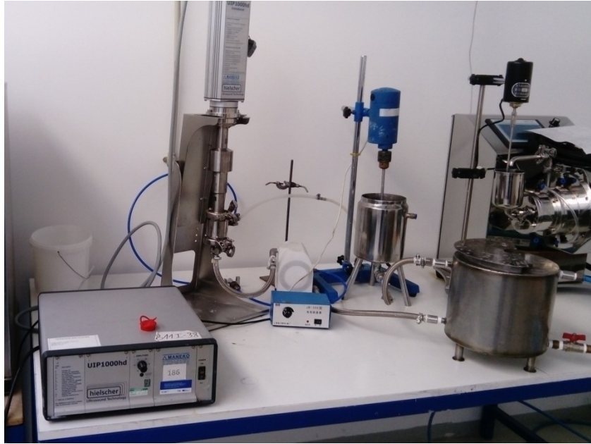
Obrázek 33. Ultrazvuková dispergace Hilsher UIP 1000 - cyklické uspořádání.
