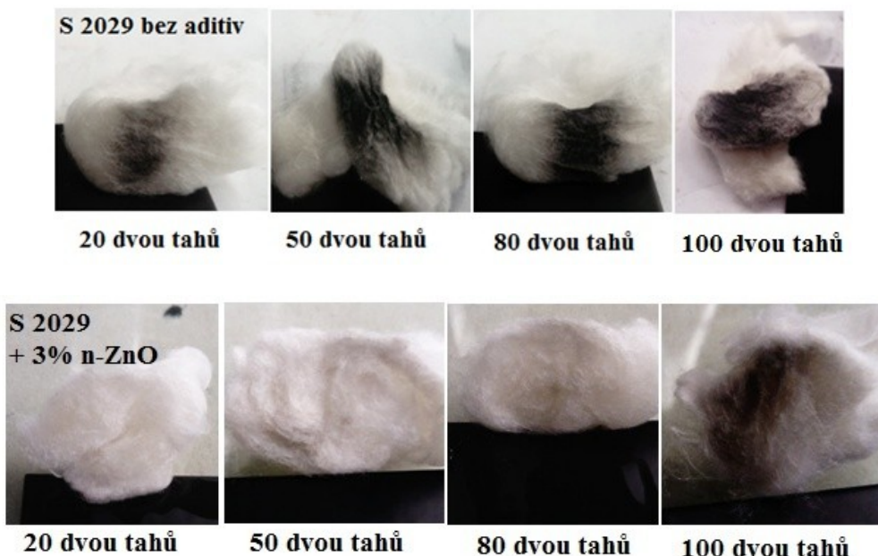
Obrázek 37. Výsledky po provedení MEK testu dle ASTM D 4752.
