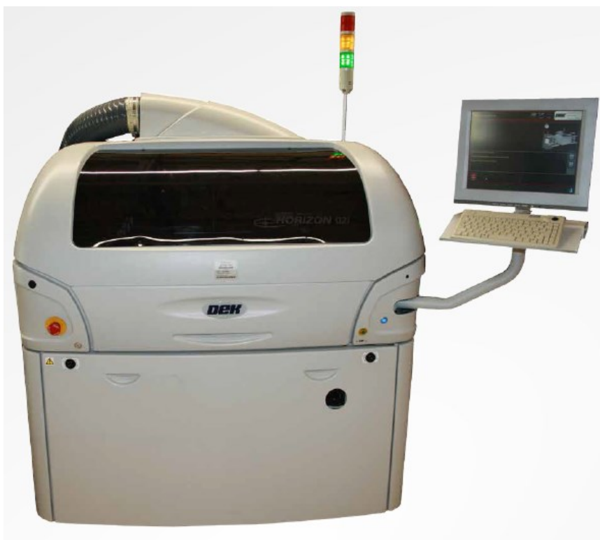
Obrázek 11 SCREEN PRINTER DEK HORIZON 02L – sítotisk pro automatické nanesení pasty (interní zdroj)
