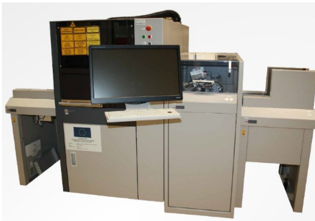
Obrázek 10 ASYS INSIGNUM 3000 LASER – laserové popisování desek plošných spojů (interní zdroj)
