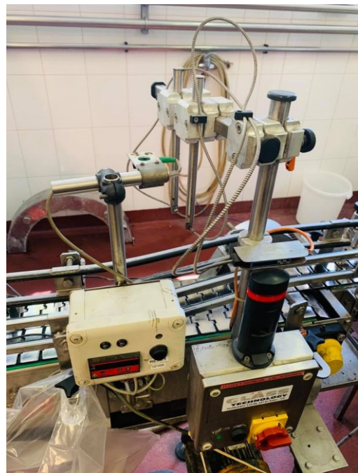
Obrázek 27 Elektronická kontrola přítomnosti korku (vlastní zpracování)
