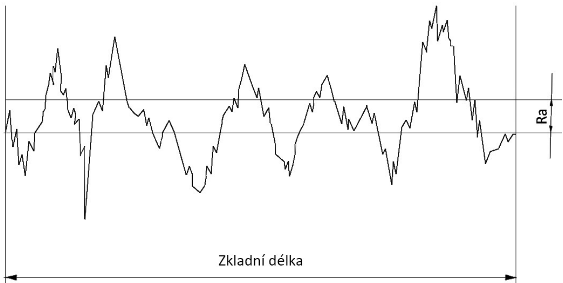
Obrázek 11 Průměrná aritmetická úchylka profilu (příklad pro drsnost profilu) [3]
