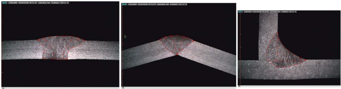
Obr. 45 Vzorčky zhotovené metodou MAG [22]
