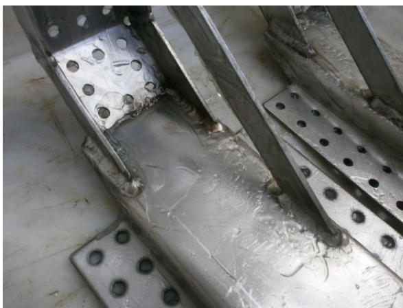
Obr. 60 Svařované díly s naneseným mořícím přípravkem [22]
