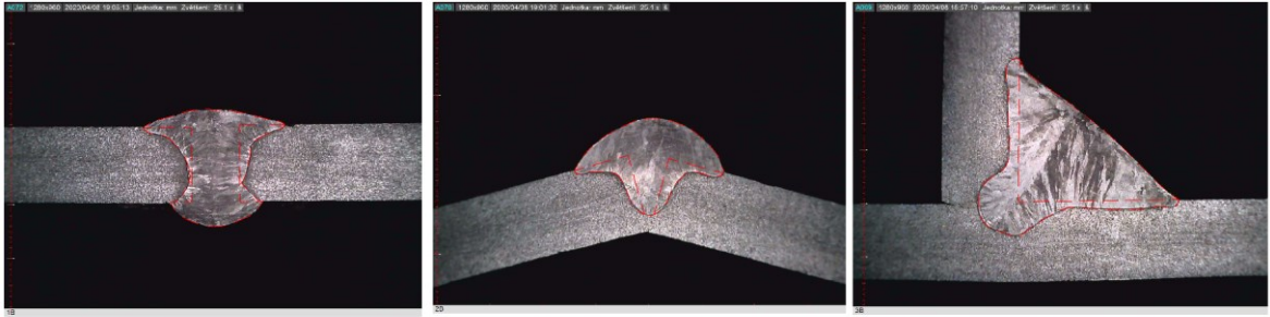
Obr. 45 Vzorčky zhotovené metodou MAG [22]
