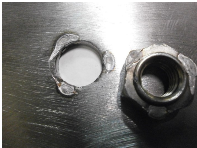
Obr. 40 Utržená matice M8 a základní materiál [22]
