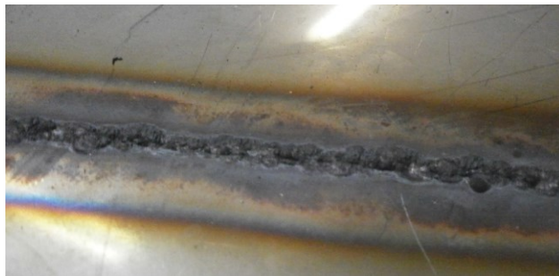
Obr. 51 Kořenová strana svaru bez použití sekundární ochrany [22]
