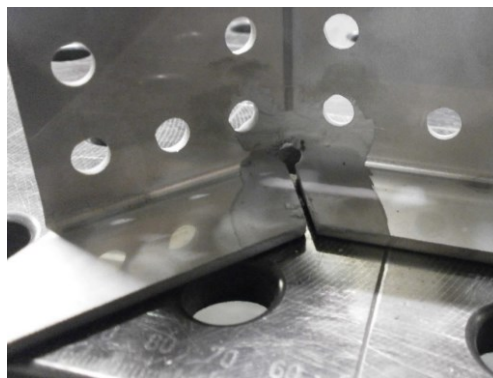
Obr. 52 Nanesená formovací pasta na kořenové straně svařovaného dílu [22]
