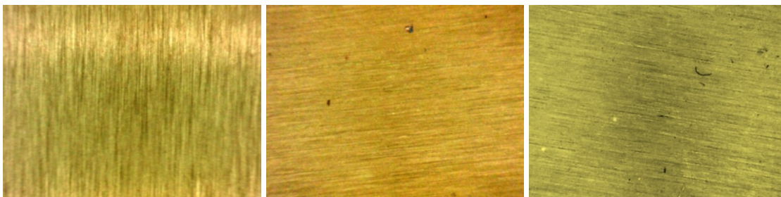
Obrázek 52 Mikroskopické snímky vzorku č. 2 – PVD TiN
