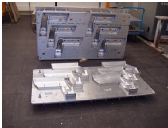
Obrázek 3 Příklad formy pro lisování EPS, EPP [8]
