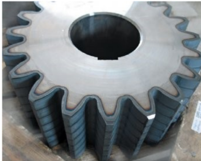
Obrázek 9 Laserově kalené ozubené kolo [23]
