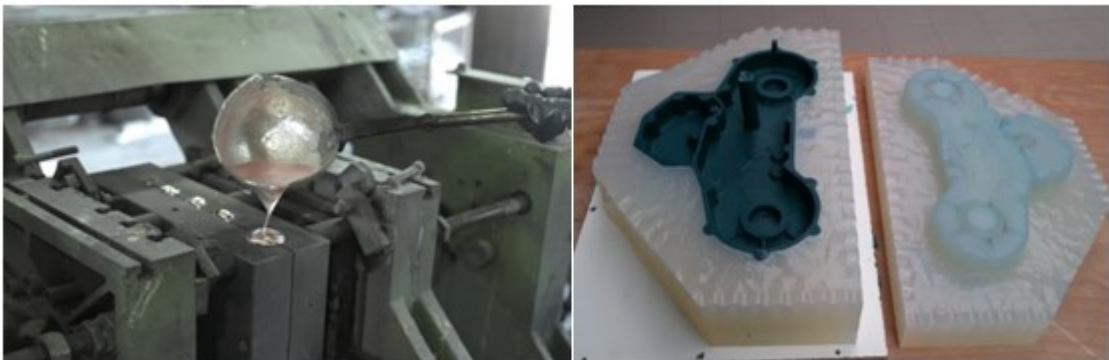
Obrázek 2 Příklady forem – vlevo pro kokilové lití hliníku, vpravo pro vakuové lití plastů [4] [5]
