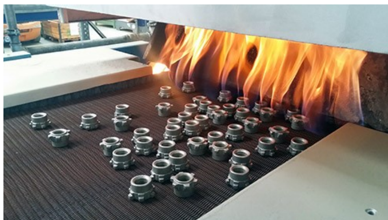
Obrázek 8 Pásová pec pro kalení a popouštění v ochranné atmosféře pro hromadné díly [22]
