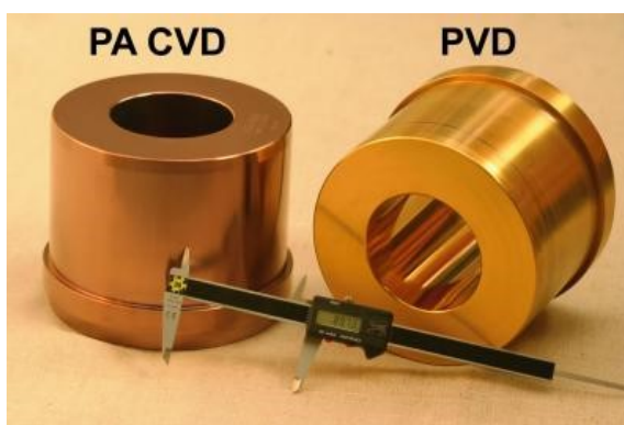
Obrázek 13 Povlakované součástky metodou PACVD a PVD [29]
