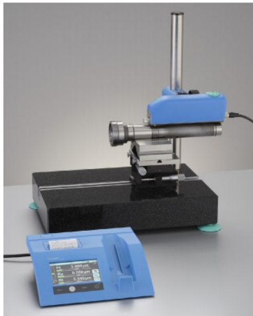
Obrázek 20 Drsnoměr Hommel Waweline W20 [36]
