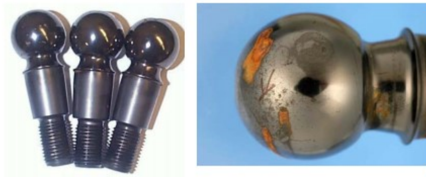
Obrázek 11 Aplikovaná karbonitridace před a po korozním testu [27]
