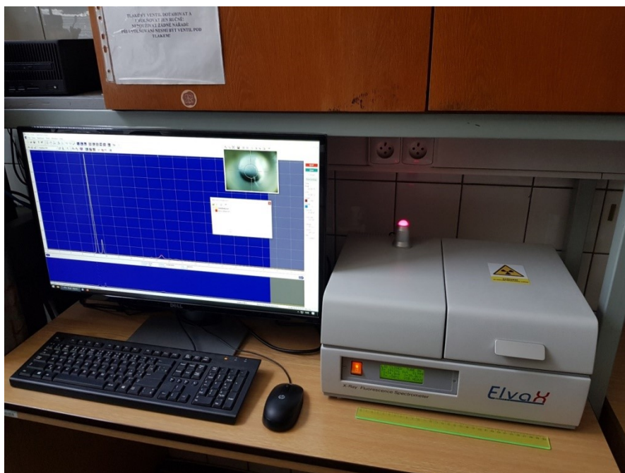
Obrázek 29 Spektrometr Elva X
