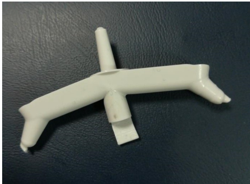
Obr. 1: Studený tunelový vtok
