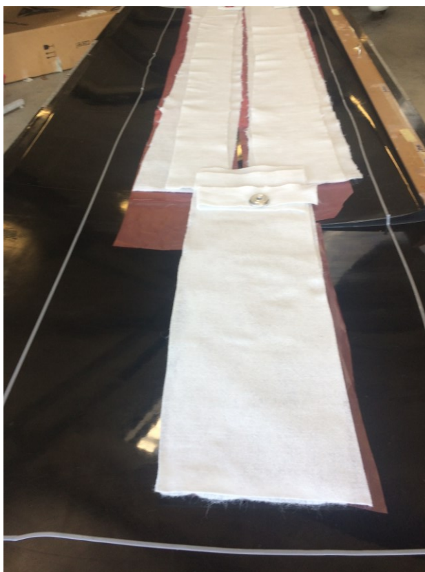
Obr. 46. Připravený laminát před vytvrzením
