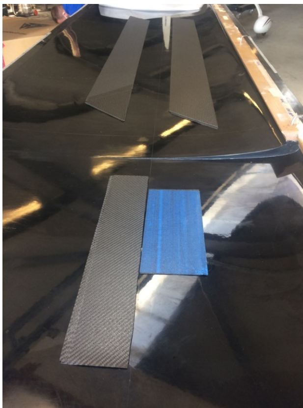
Obr. 46. Připravený laminát před vytvrzením
