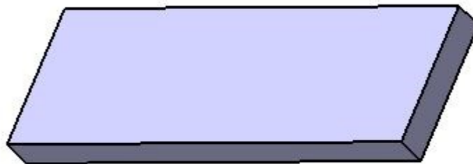
Obr. 59. Zkušební vzorek pro zkoušku ohybem krátkého nosníku
