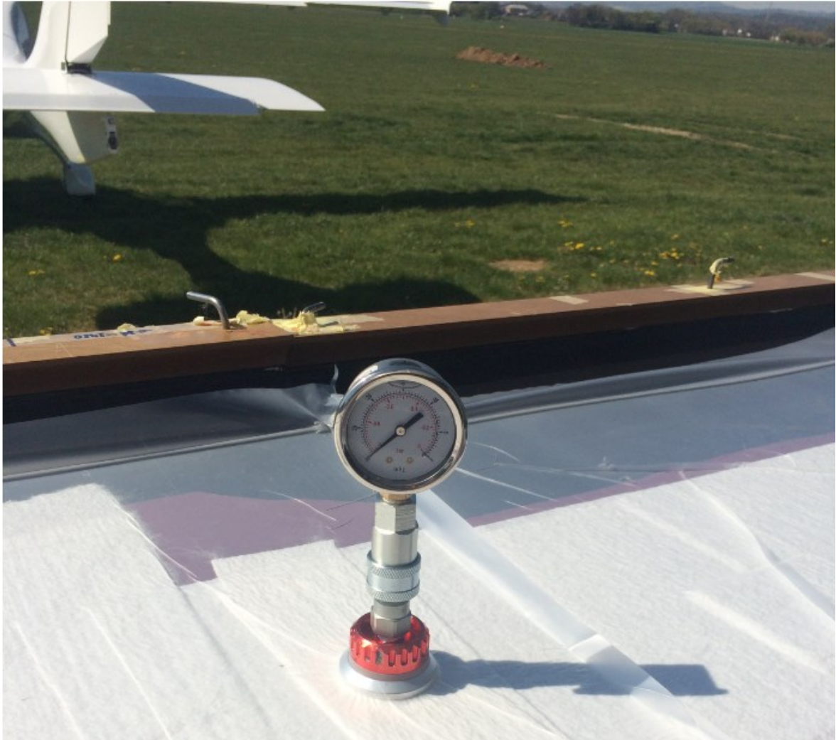
Obr. 49. Barometr s hodnotou podtlaku -1 Bar
