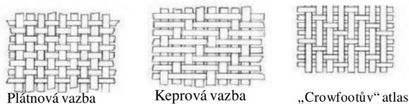
Obr. 5 Rozdělení textilních vazeb vláknových výztuží s dlouhými vlákny [1].
