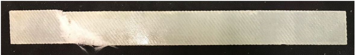
Obr. 42 Zkušební těleso ze sklolaminátu po statické zkoušce
