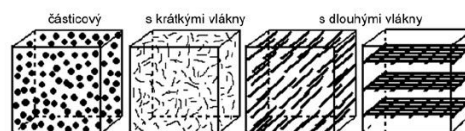
Obr. 4 Rozdělení kompozitních materiálů dle geometrických tvarů výztuže [2].
