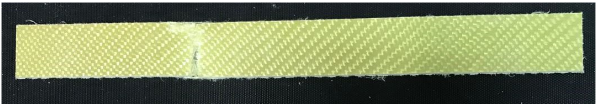
Obr. 43 Zkušební těleso z kompozitu s aramidovými vlákny po statické zkoušce
