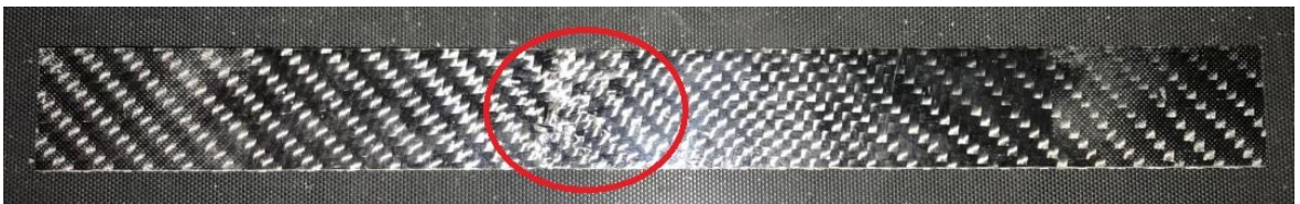
Obr. 54 Zkušební těleso z kompozitu s uhlíkovými vlákny po dynamické zkoušce
