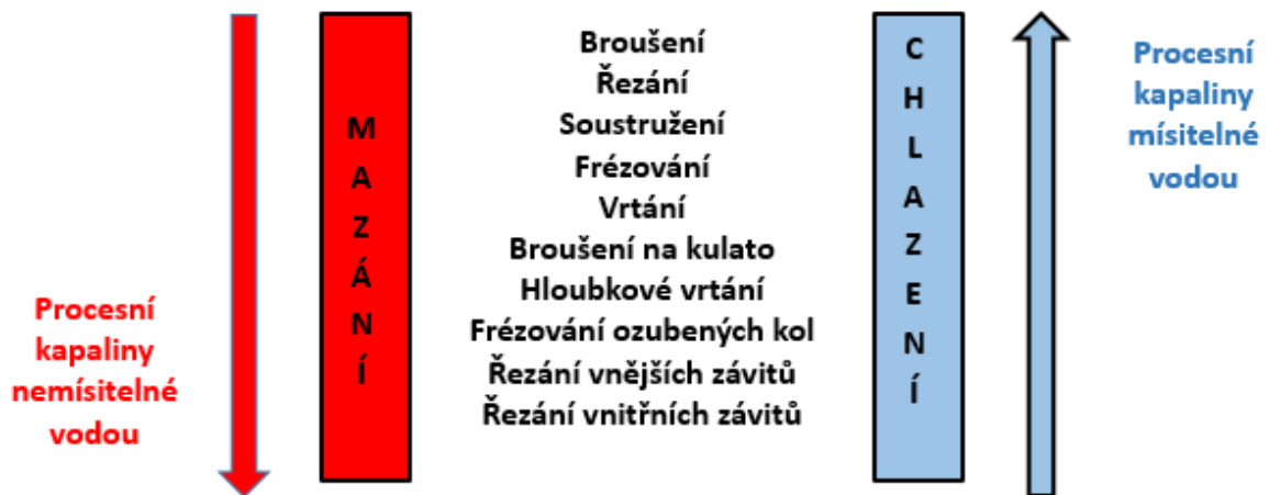
Obr. 1 Chladící a mazací účinek procesních kapalin na řezný proces [1]
