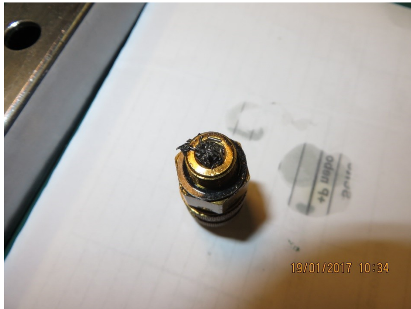
Obr. 23 Ucpaný díl rozvodu procesní kapaliny třískami [27]
