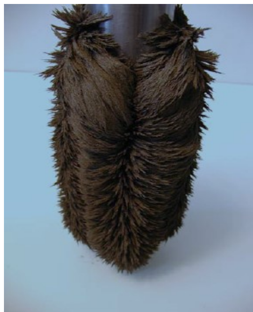
Obr. 52 Zachycené nečistoty na magnetickém jádru [27]
