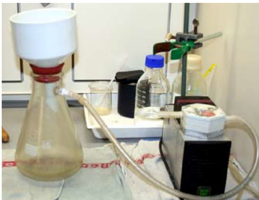
Obr. 22 Aparatura pro laboratorní zjišťování obsahu nečistot v oleji [27]
