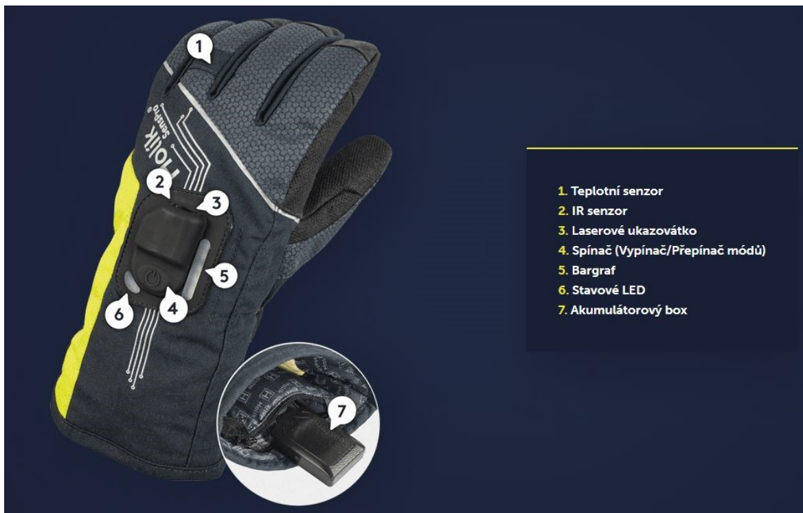
Obrázek 6. Rozmístění funkčních prvků na hřbetové straně rukavice SensPro® (Holík International, 2019b)
