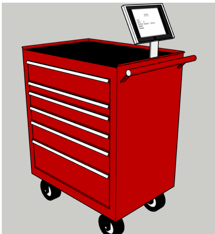
Obrázek 56 Dílenský vozík s napevno zabudovaným tabletem (vlastní zpracování dle interních materiálů)
