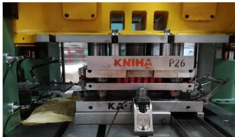
Kulaté podložky se šrouby na beranu, 3x upinka na stole, nastavení zadní rolny a čidla
