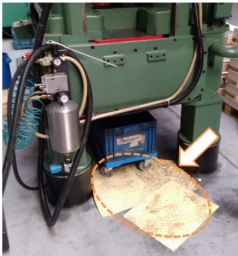
Obrázek 47 Sorpční textilie pro zachytávání unikajícího oleje z olejové vany centrálního systému mazání (vlastní zpracování)
