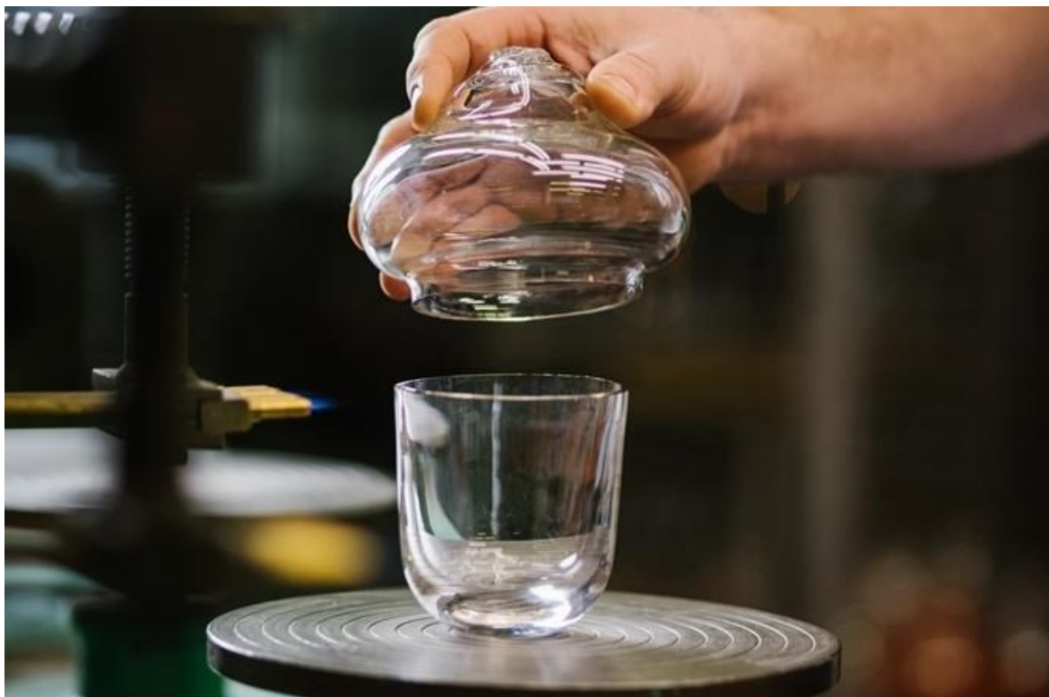
Obrázek 25, Oddělení hlavy (kopny) od skleněného výrobku
