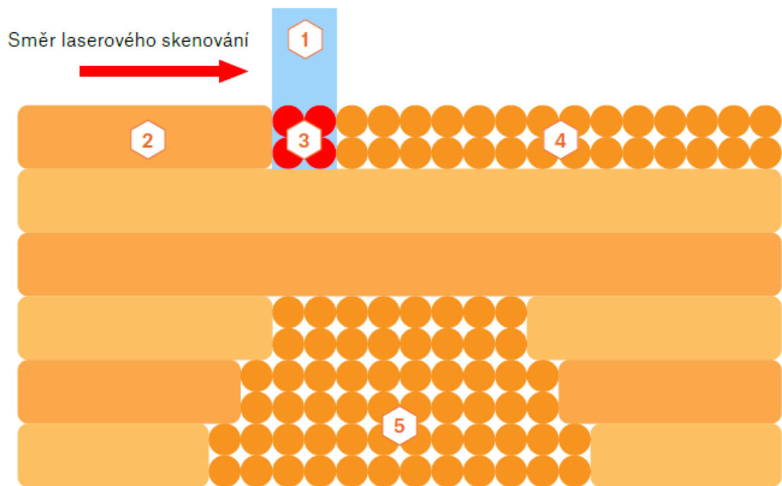
Obrázek 35: Princip SLA/DMLS tisku [13]
