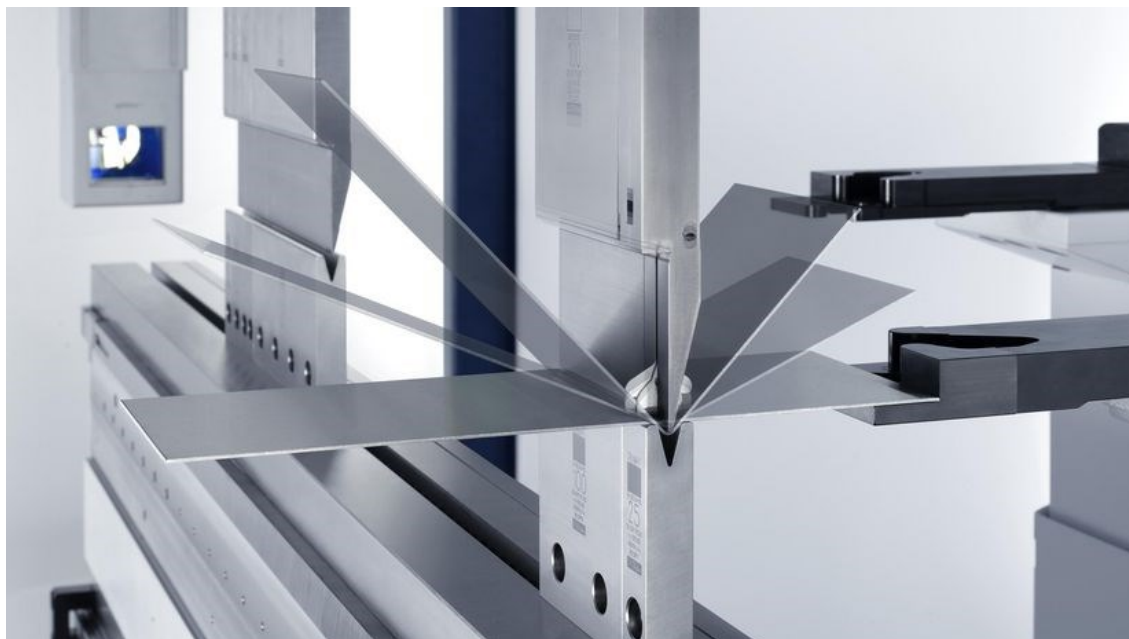
Obrázek 13. Úhlový snímač ACB [7]
