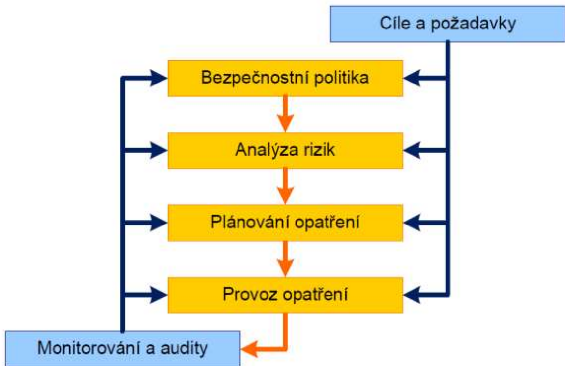
Obr. 4. Schéma základních procesů řízení bezpečnosti informací dle ITIL (Information Technology Infrastructure Library). [41]
