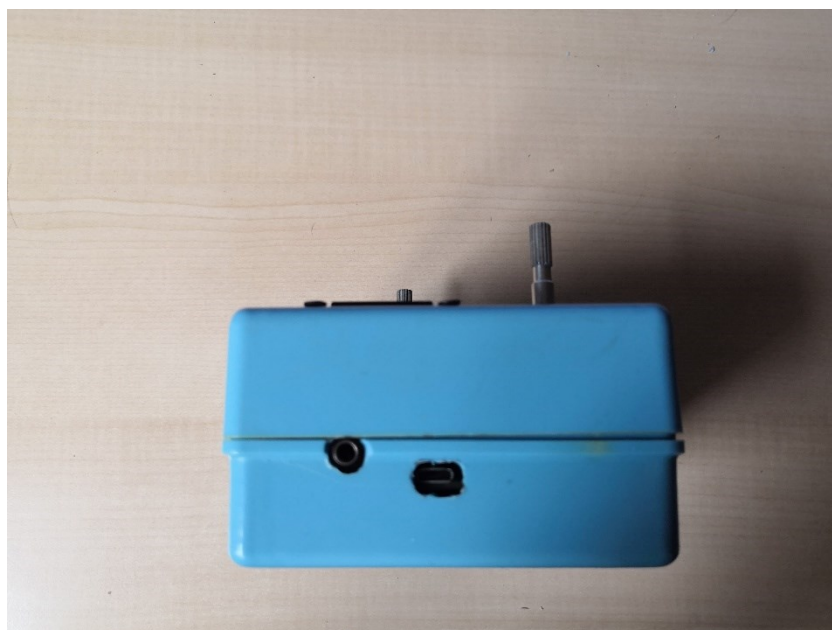
Pohled zleva - Vstup pro mikro USB zde může sloužit jako napájení i jako MIDI vstup
