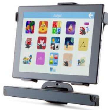
Obrázek 18 Irisbond DUO myš ovládaná pohybem očí [35]
