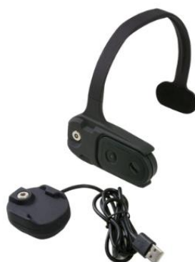
Obrázek 17 Quha Zono+Nemo myš ovládaná pohybem hlavy [32]
