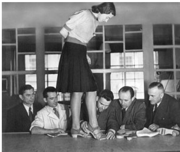
Zaměstnanci modelárny při testech flexibility dřevěné podešve, kolem 1941.
