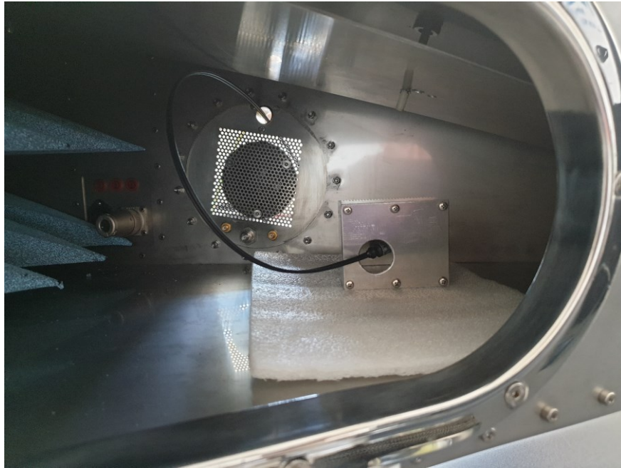
Obr. 58 Sonda uzavřena v krytu, umístěna boční stranou vůči výstupu
