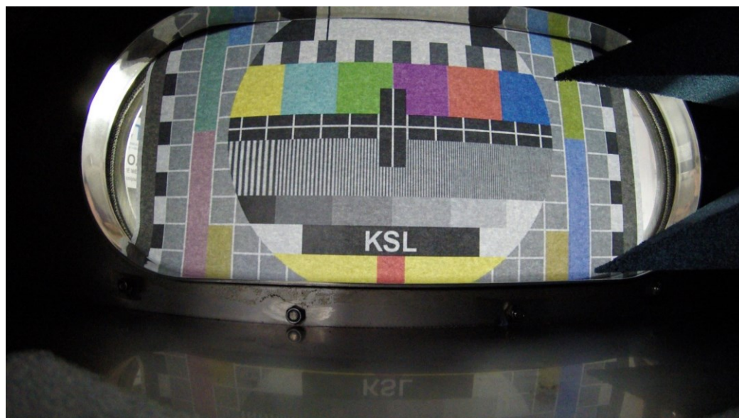
Obr. 55 TV color tester zaznamenaný samotnou kamerou během rušení na kmitočtu 360 MHz
