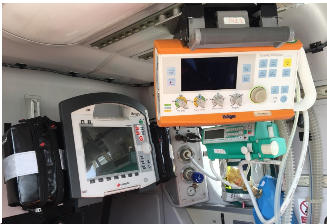
Obrázek 8 – Zdravotnické přístroje ve vrtulníku EC 135 T2+ (zleva: Defibrilátor, Oxylog 3000 a lineární dávkovač Perfusor Compact S) [Zdroj: vlastní]
