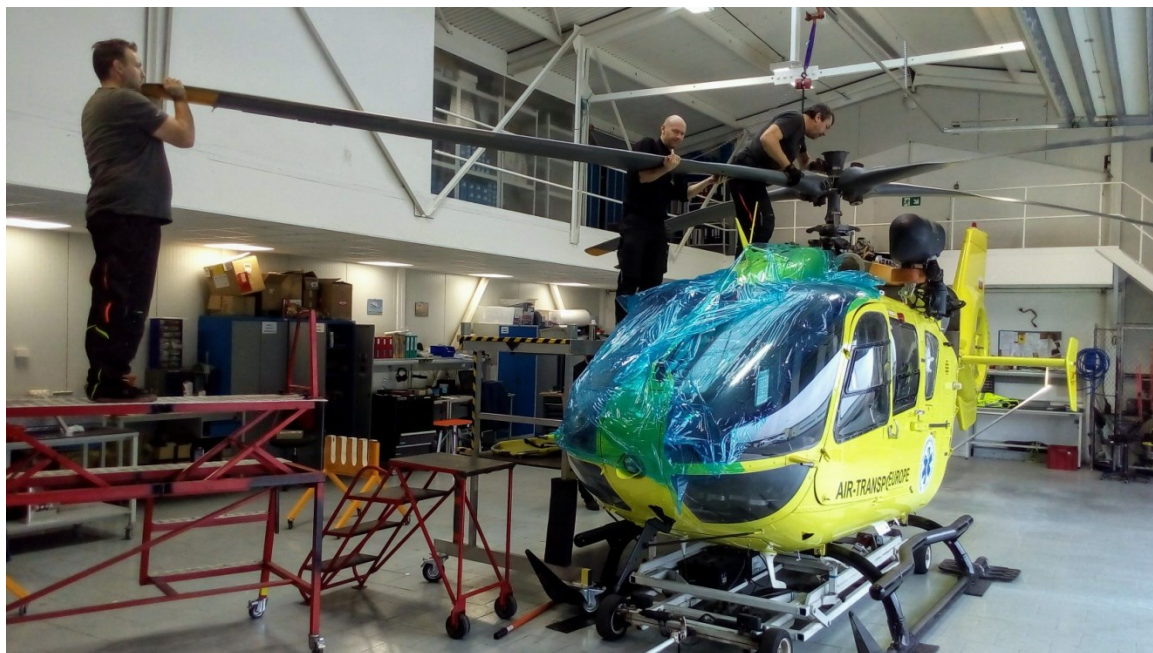
Obrázek 9 – Nasazování listů rotoru u vrtulníku EC 135 T2+ (ATE) [Zdroj: vlastní]
