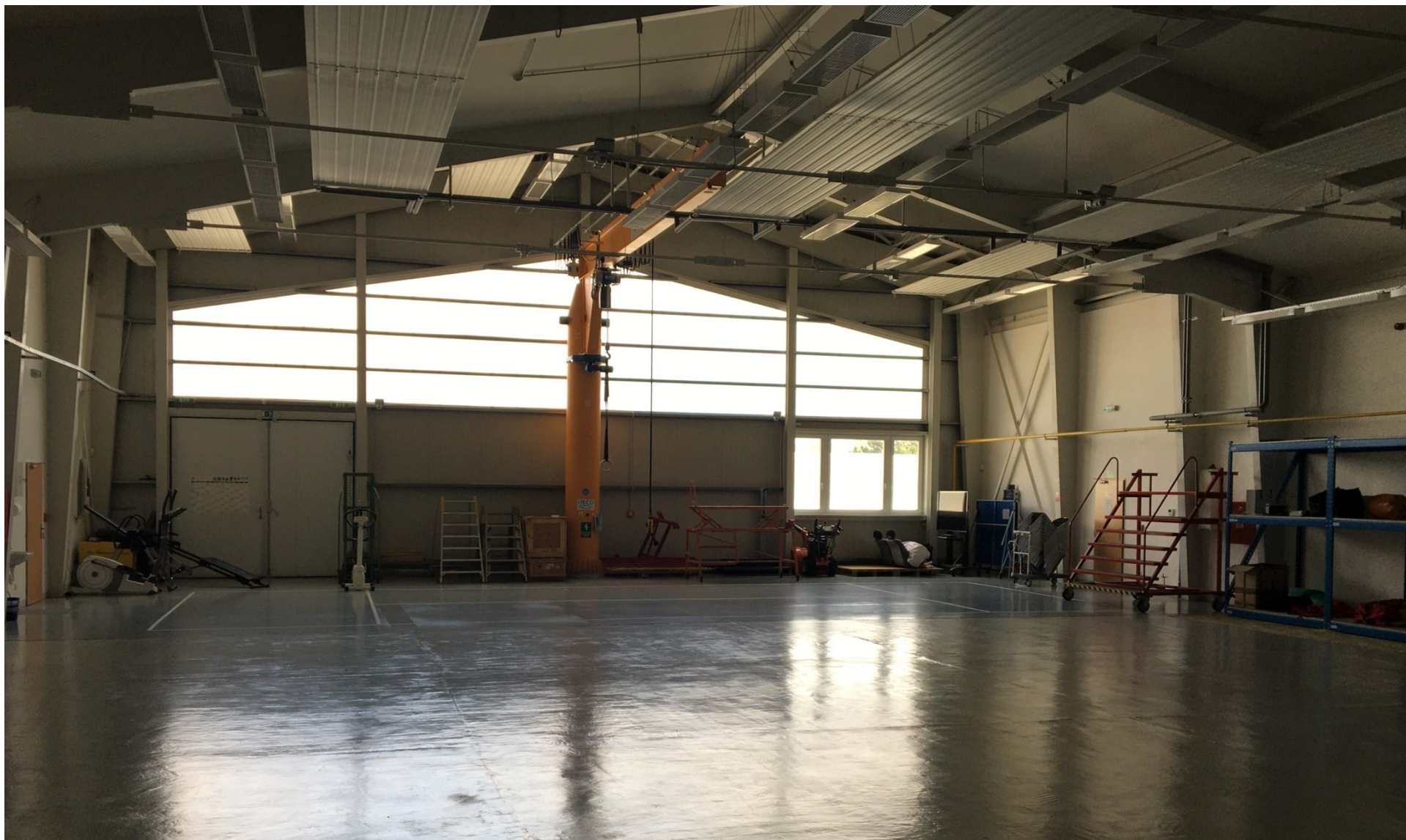
Příloha 8 – Hangár LZS s jeřábem ITECO s nosností 2000 kg
