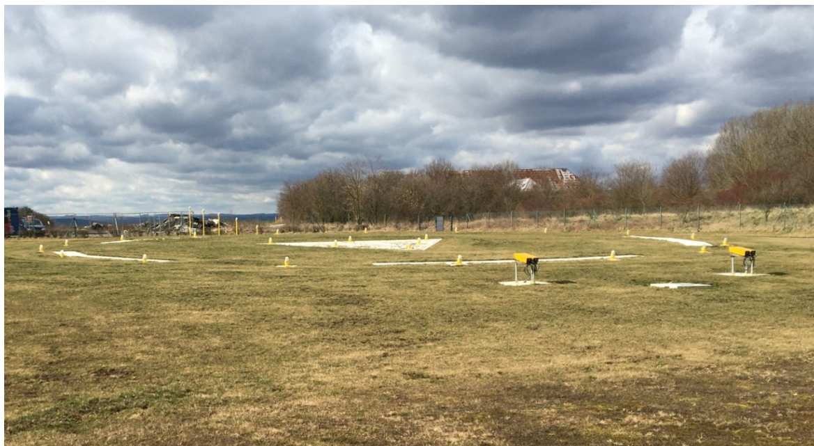
Obrázek 6 – Značení konečného přiblížení FATO 2 včetně zaměřovacího obrazce a návěstidla PAPI TP 90 [Zdroj: vlastní]
