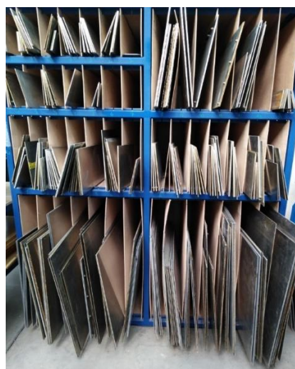
Obrázek 18 Regálový systém pro základny a krycí plechy, (Vlastní zdroj)
