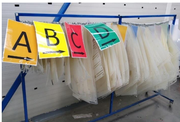
Obrázek 16 Nové uložení šablon na dílně do stojanu, (Vlastní zdroj)
