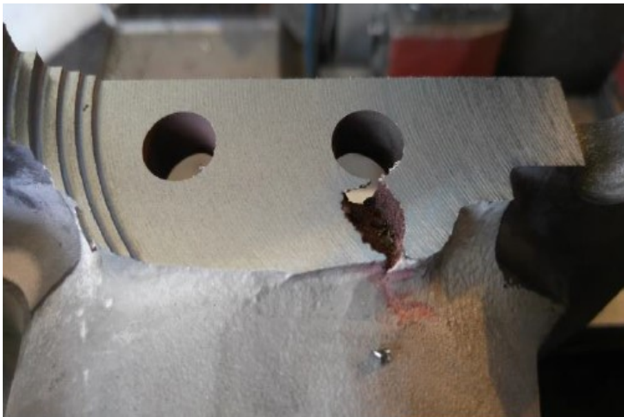
Obrázek 39: Odebírání materiálu v hloubce 16 mm
