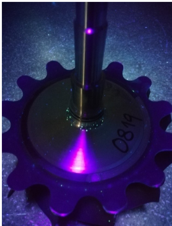
Obrázek 467: Kapilární zkouška s implementací přídavku 1 mm
