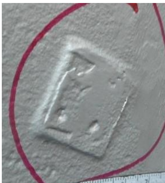
Obrázek 24: Nedostatečně rozpuštěná podpěrka
