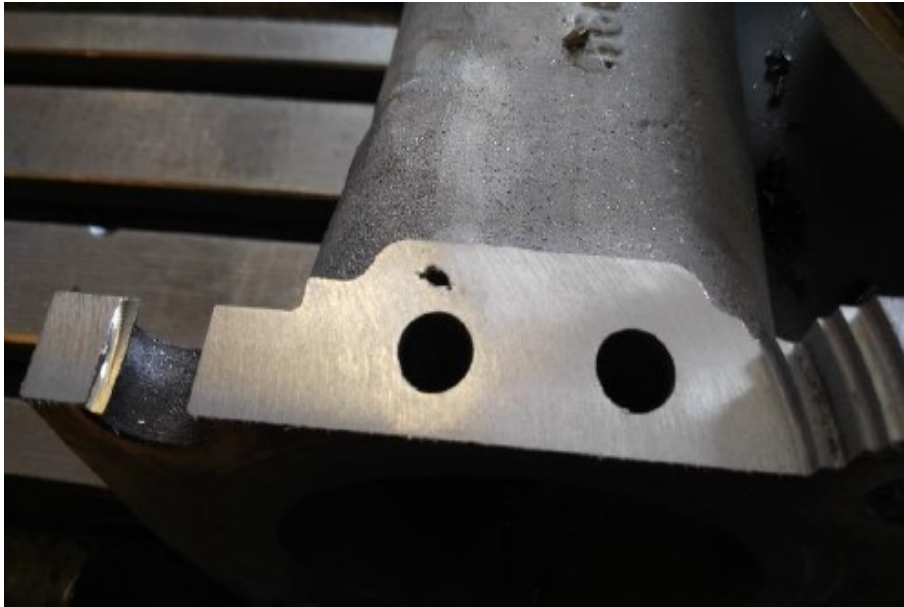
Obrázek 38: Odebírání materiálu v hloubce 10 mm
