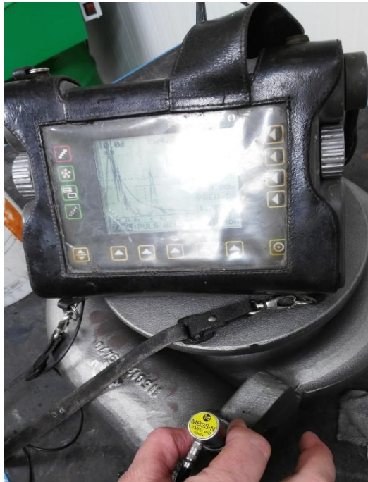
Obrázek 41: Zkouška ultrazvukem (odrazová metoda)
