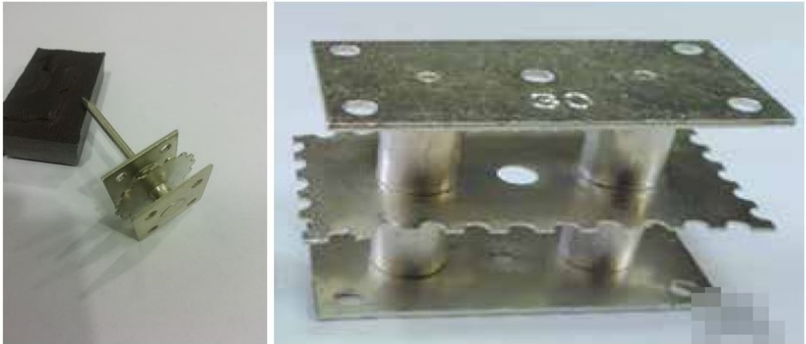
Obrázek 34: Původní (vlevo) a nový (vpravo) typ podpěrek
