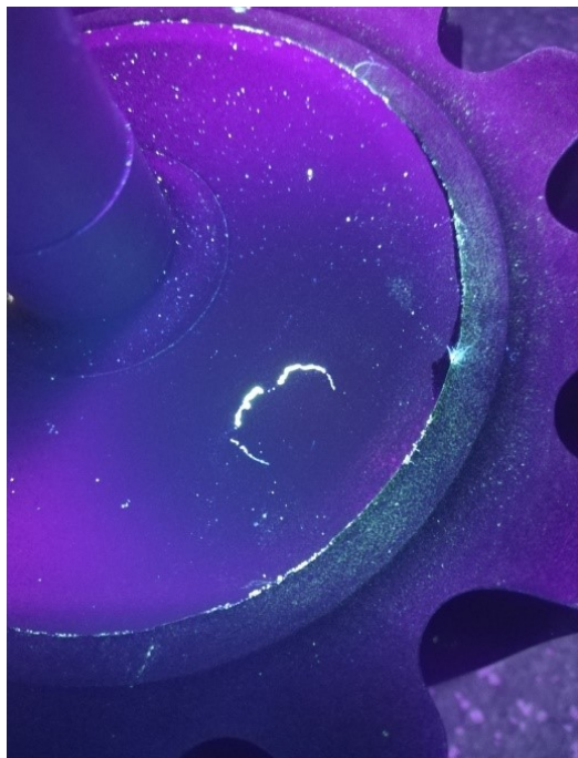
Obrázek 45: Indikace při kapilární zkoušce pod UV světlem
