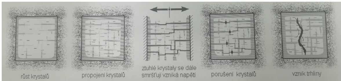
Obrázek 9: Vznik trhliny [1]
