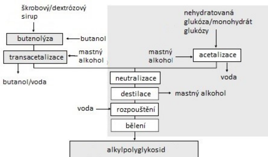
Obr. 7. Způsob výroby alkylpolyglukosidů [převzato a upraveno z [15].
