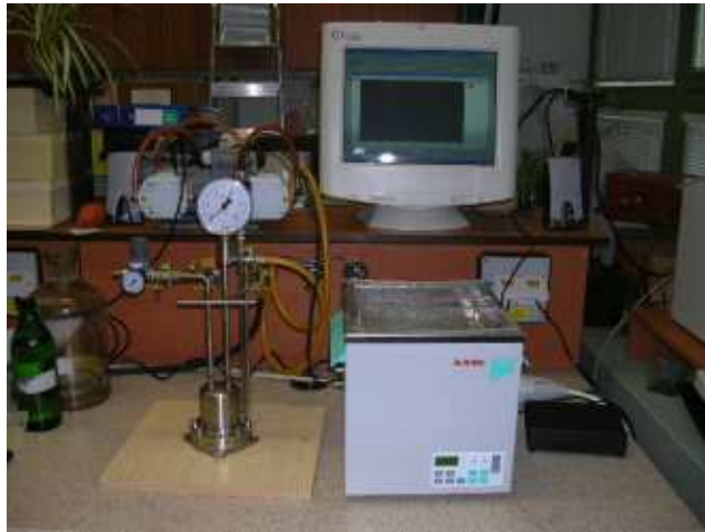
Obr. 8 Reálný pohled na měřící zařízení metodou konstantního objemu
