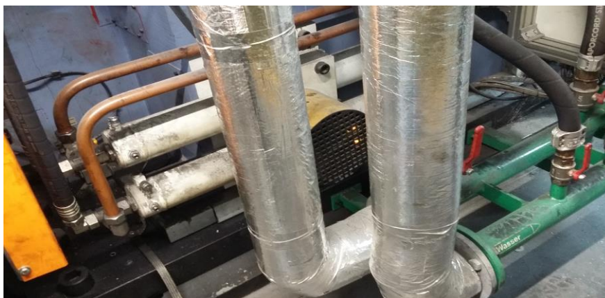
Obrázek 5 Umístění hydropohonu spodního uzávěru. (vlastní zpracování)
